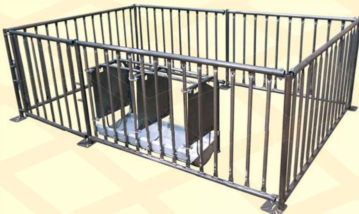
Рама стенок и калитки станка изготовлены из стальной электросварной трубы  $\Phi 42 \times 3$ , а поперечные трубы изготовлены из электросварной трубы  $\Phi 25 \times 1,5$ . Все открытые концы труб закрыты полиэтиленовыми заглушками. Шкворень изготовлен из круга 12. Остальные детали выполнены из стального листа толщиной 5...8 мм. Все элементы конструкции защищены от коррозии горячим цинкованием.
